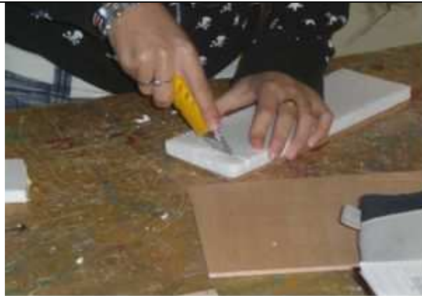
Recorte del material empleado como aislante en las paredes exteriores y el suelo. Poliestireno expandido.
