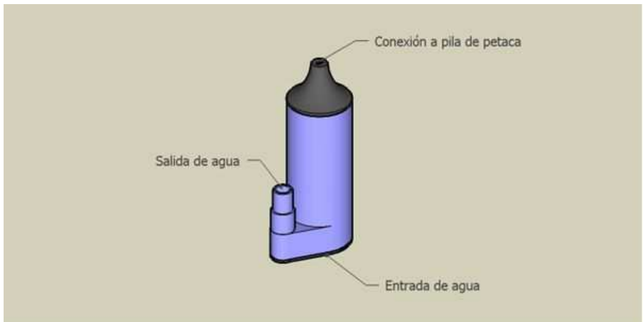
Figura nº 34. Bomba de agua.
