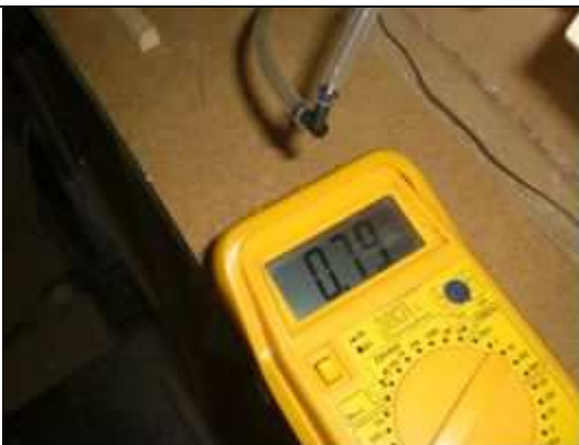
Medición con el polímetro, de la energía eléctrica real proporcionada por la central eólica. 0,79 V.
