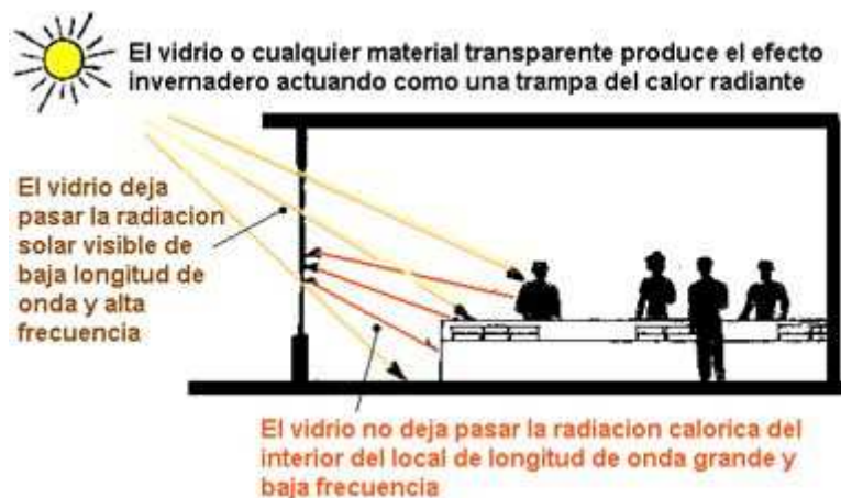
Figura nº 14. Efecto invernadero en las viviendas.
