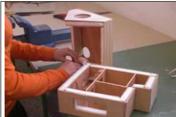
Colocación de doble láminas de plástico en ventanas, para la rotura del puente térmico.
