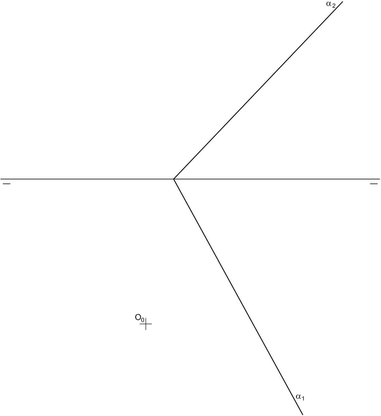
Dibujar las proyecciones de una circunferencia de centro O y diámetro 60 mm, que está en el plano  $\alpha$ . Se da el abatimiento,  $O_0$ , sobre el PH del centro.
