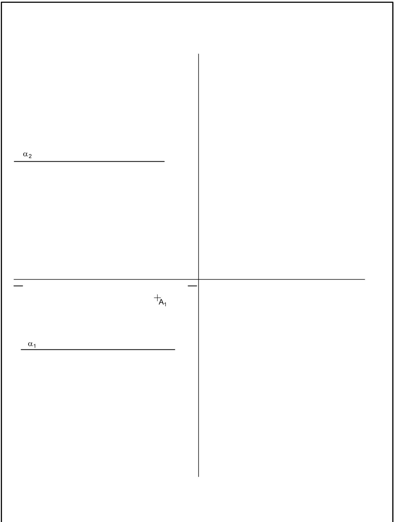
Dibujar las proyecciones y verdadera magnitud de un rombo áureo, apoyado en el plano  $\alpha$ , cuya diagonal mayor AC, que mide 70 mm, tiene su vértice C en la traza horizontal,  $\alpha_1$ , del plano  $\alpha$  y a la izquierda del vértice A. El rombo está en el 1º cuadrante. Abatir sobre los tres planos: PH, PV y PP.
