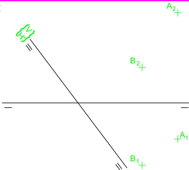
Determinar las nuevas proyecciones del segmento  $\overline{AB}$ , mediante el cambio de plano horizontal indicado.
