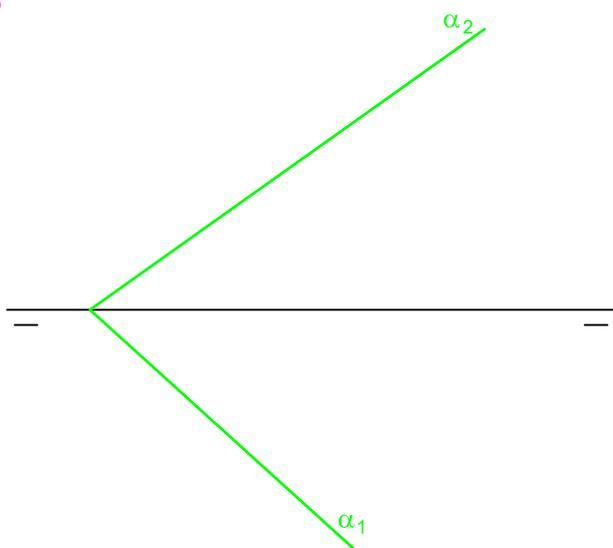
Transformar mediante cambio de plano, el plano oblicuo  $\alpha(\alpha_1, \alpha_2)$  en un proyectante vertical (de canto).
