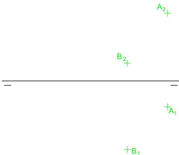
Determinar mediante cambio de planos, la magnitud del segmento  $\overline{AB}$ .
