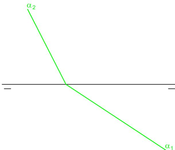
Transformar mediante cambio de planos, el plano oblicuo  $\alpha(\alpha_1, \alpha_2)$  en un proyectante horizontal (vertical).
