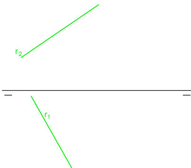
Transformar mediante cambio de planos la recta,  $r(r_1, r_2)$ , en una recta paralela a la LT.
