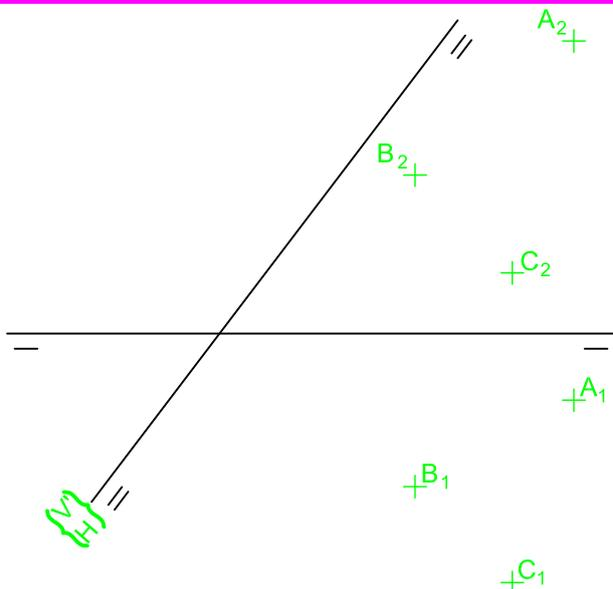
Determinar las nuevas proyecciones del triángulo ABC, mediante el cambio de plano vertical indicado.
