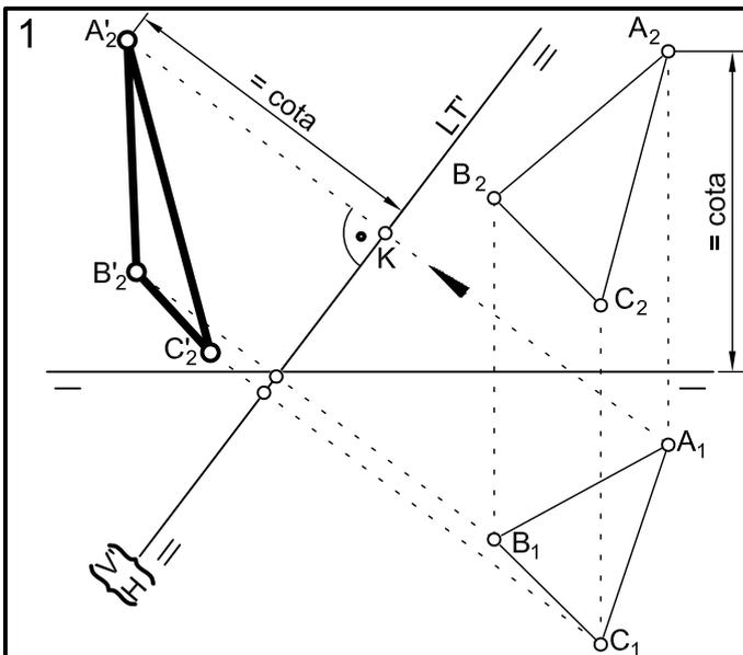
1 Determinar las nuevas proyecciones del triángulo ABC, mediante el cambio de plano vertical indicado.
