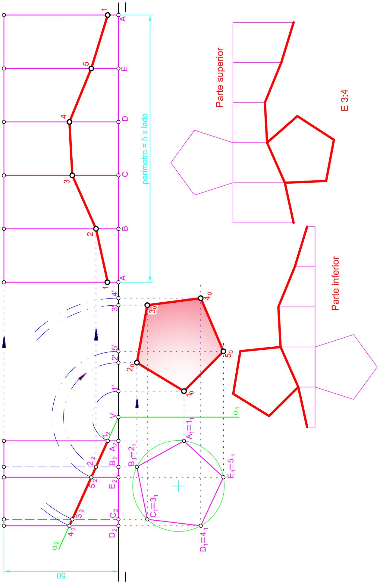
Dibujar la sección producida por el plano  $\alpha$  al prisma recto regular pentagonal de altura 50 mm, obteniendo su verdadera magnitud. En la parte derecha de la lámina obtener el desarrollo del prisma y de la sección. Se da la proyección horizontal de un de los vértices, así como la circunferencia donde está inscrita la base.
