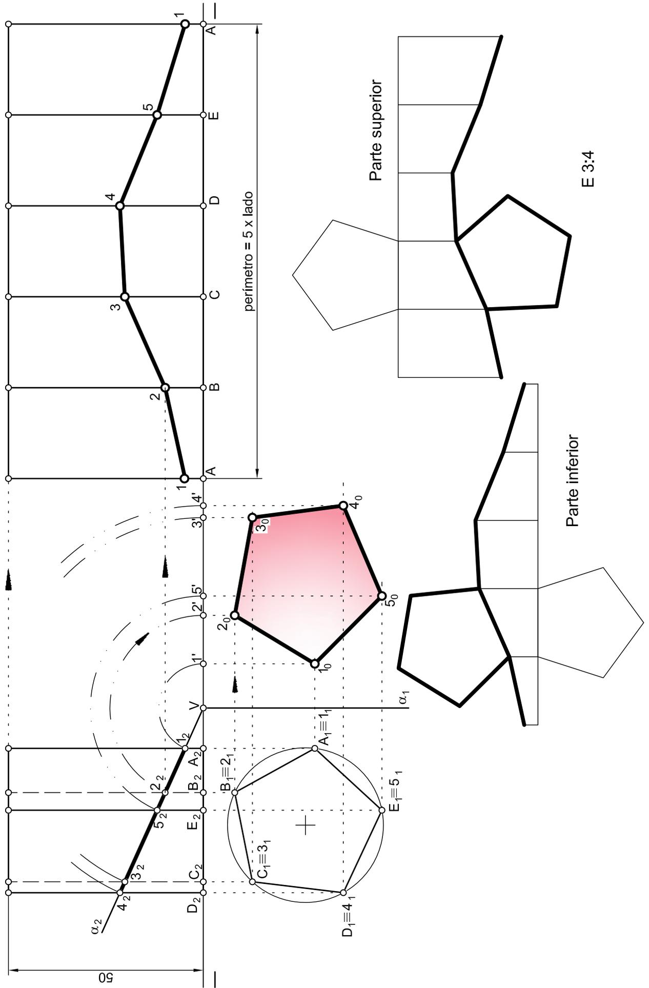
Dibujar la sección producida por el plano  $\alpha$  al prisma recto regular pentagonal de altura 50 mm, obteniendo su verdadera magnitud. En la parte derecha de la lámina obtener el desarrollo del prisma y de la sección. Se da la proyección horizontal de un de los vértices, así como la circunferencia donde está inscrita la base.
