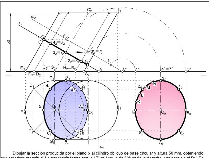
Dibujar la sección producida por el plano  $\alpha$  al cilindro oblicuo de base circular y altura 50 mm, obteniendo su verdadera magnitud. La generatriz forma con la LT un ángulo de 60° hacia la derecha y es paralela al PV. En la parte inferior de la lámina obtener el desarrollo del prisma y de la sección.
