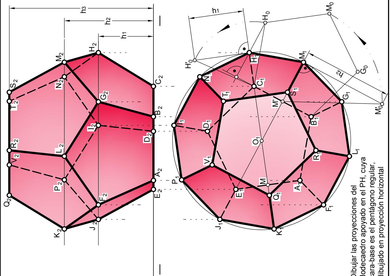
Dibujar las proyecciones del dodecaedro apoyado en el PH, cuya cara-base es el pentágono regular, dibujado en proyección horizontal
