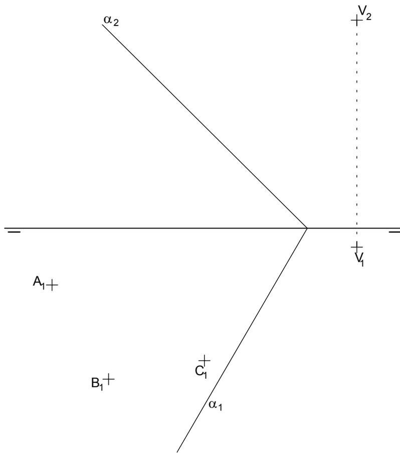
Dibujar las proyecciones, verdadera magnitud y desarrollo, de la sección que produce el plano  $\alpha$ , a la pirámide oblicua, de base triangular y vértice,  $V$ , dada. Utilizar el procedimiento de cambio de plano.
