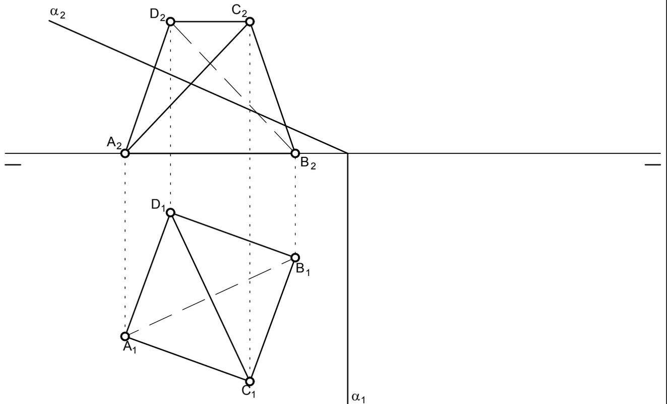
Aprovechando una de las posiciones vistas en la lámina diédrico 17, se pide seccionar el tetraedro por el plano  $\alpha$ , obteniendo s verdadera magnitud y el desarrollo del tetraedro así como de la sección en la parte inferior de la lámina.
