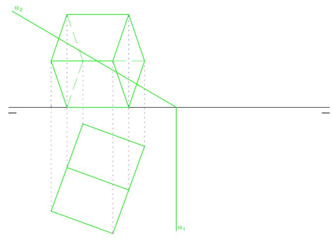
Aprovechando una de las posiciones vistas en la lámina 18, se pide seccionar el cubo por el plano  $\alpha$ , obteniendo su verdadera magnitud y el desarrollo del cubo así como de la sección en la parte inferior de la lámina.
