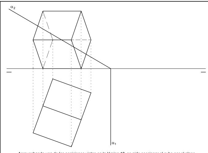
Aprovechando una de las posiciones vistas en la lámina 18, se pide seccionar el cubo por el plano  $\alpha$ , obteniendo su verdadera magnitud y el desarrollo del cubo así como de la sección en la parte inferior de la
