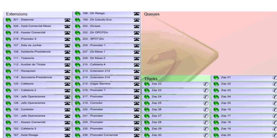
Fig. 9.2 Panel FOP en acción con Extensiones y Troncales
