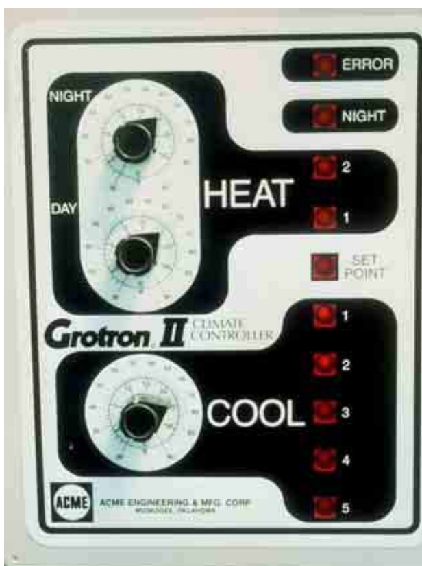
Figura 1.4.8 Los controles climáticos regulan el calentamiento o enfriamiento en una serie de etapas cercanas al punto deseado de temperatura.
