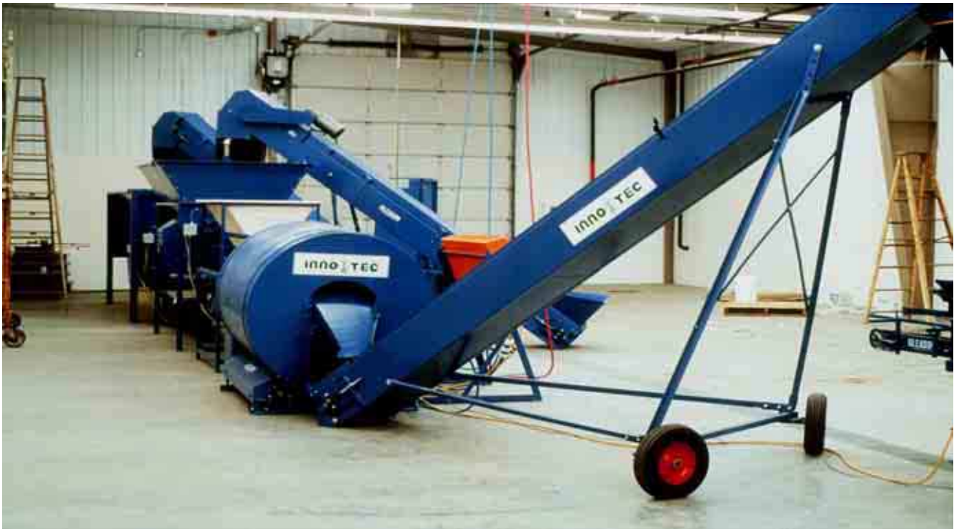
Figura 1.4.22 Pequeñas cantidades de sustrato pueden ser mezcladas manualmente o en revolvedoras de concreto (A), pero los viveros grandes usan un conjunto de mezcladoras de lotes para abastecer continuamente con sustrato la línea de llenado y siembra (B). El equipo de mezclado continuo ha sido diseñado para asegurar un mezclado homogéneo y distribuir los materiales incorporados, sin alterar la estructura física de los componentes (C). (C, cortesía de J. Reid, Inno-Tec, Thunder Bay, ON, EUA).
