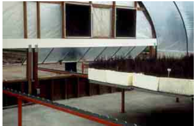
Figura 1.4.15 En años recientes, las mesas móviles o deslizables han llegado a ser más populares y son de dos tipos (A). Con el diseño lateral, los extremos de la cama se mueven hacia los lados en forma manual o con una manija especial (B y C), para generar un pasillo temporal. El diseño "Lado a Lado" se caracteriza porque las plataformas se deslizan a lo largo de la estructura de propagación (D) y pueden ser usadas para transportar los contenedores al área de endurecimiento o de empacado (E). (A, adaptado de Aldrich y Bartok, 1989).
