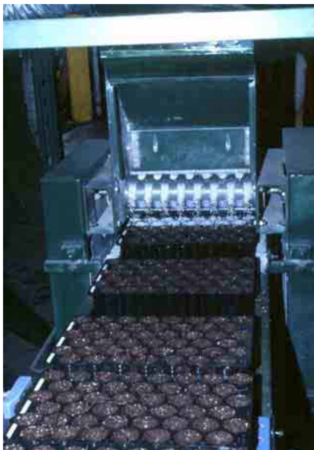
Figura 1.4.23 La línea de siembra consiste de una serie de operaciones secuenciadas, las cuales pueden ser mecanizadas para incrementar la calidad y velocidad: llenado de contenedores (A), compactado del sustrato en el contenedor para la siembra (B), siembra (C) y tapado de la semilla (D) ( continúa ).
