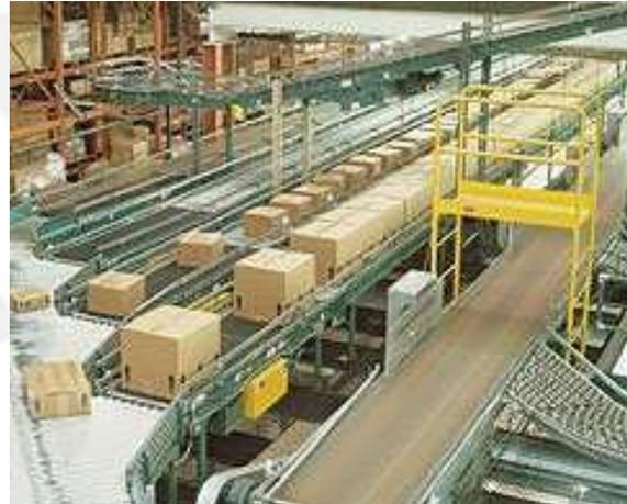
En procesos automatizados, sistemas complejos de bandas y rodillos son ampliamente utilizados para transportar y clasificar, utilizando sensores y lectores de código de barras
