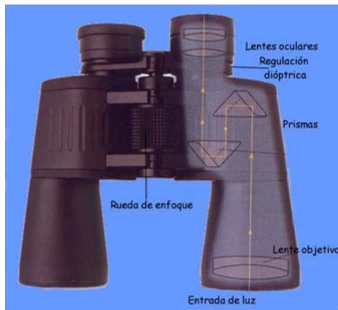
Esquema de corte de unos binoculares.
