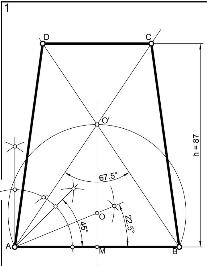
Dibujar un trapezio isósceles, del que se conoce la base  $b$  (dibujada), su altura  $h = 87$  mm y el ángulo de  $67.5^\circ$ , que forman las diagonales opuesto a la base  $b$ .
