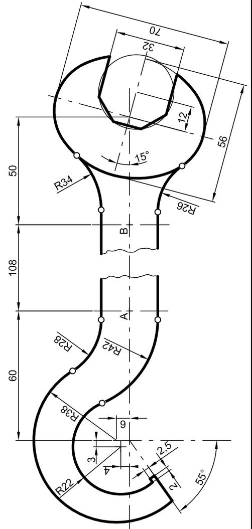
Dibujar la Llave de Gancho, a la escala 1:1, que se muestra a la izquierda. Se dan los puntos A y B de referencia para situar el dibujo. Se han indicado los puntos de tangencia, por unos círculos pequeños.
