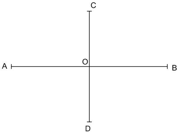
Dibujar la elipse de ejes  $\overline{AB}$  y  $\overline{CD}$ , por el procedimiento de afinidad.
